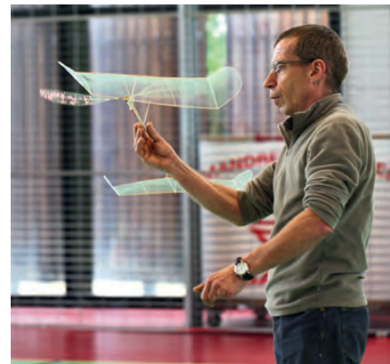
Sylvain Prunier vient de lâcher son F1D. On devine la souffrance du modèle au départ, due à la puissance, et on visualise la torsion des ailes liée au couple de l'hélice.
