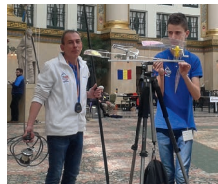
Elliott place le moteur élastique remonté sur son modèle.
